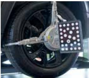
Utilizzando una forza ottimale, l'ancora si attacca al pneumatico senza entrare in contatto con il cerchione, garantendo un'operazione di serraggio sicura, rapida e uniforme.
