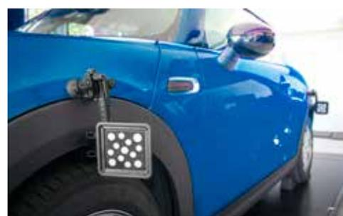
L'utilizzo dei bersagli per l'altezza scocca opzionali appositamente progettati consente di eliminare l'inserimento manuale dei dati, accelerare la misurazione e aumentare la precisione.
